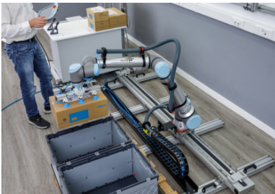
Eje eléctrico Festo con Robot colaborativo
